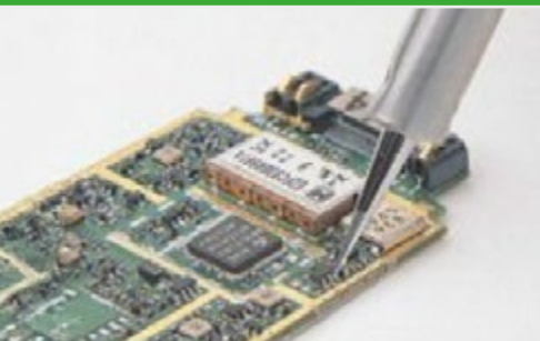
LUTOWANIE RĘCZNE W TECHNOLOGII POWIERZCHNIOWEJ - SMT
