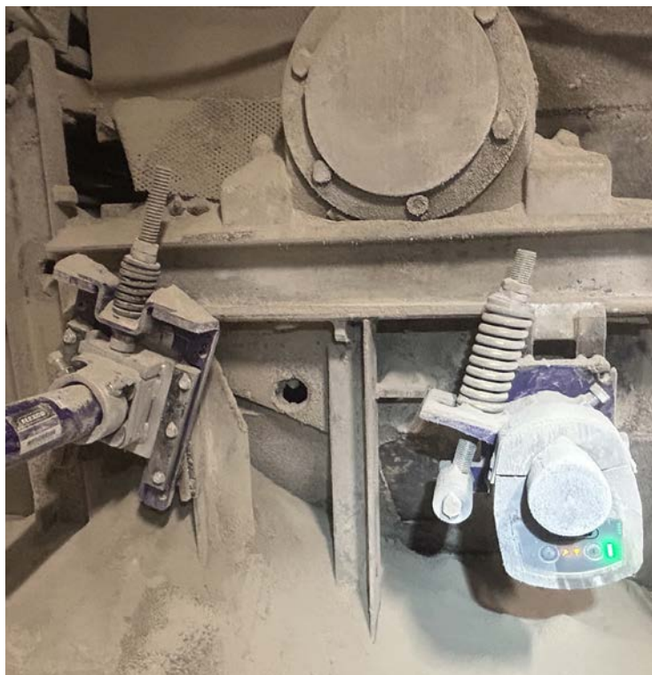
System Flexco Elevate monitorujący pracę skrobaka i stan taśmy
