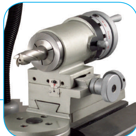
Możliwość ostrzenia frezów kulistych dzięki urządzeniu DM 2776 montowanemu na stole roboczym ostrzałki
